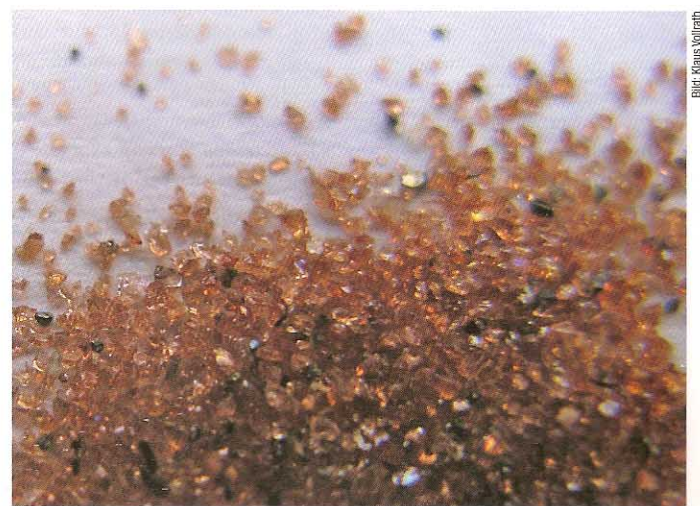
Als Abrasivstoff kommt beim Wasserstrahlschneiden bevorzugt Granatsand in unterschiedlichen Korngrössen zum Einsatz.
