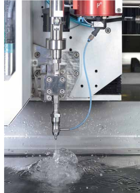
Ein moderner Mikro-Wasserstrahlschneidkopf ©Waterjet
