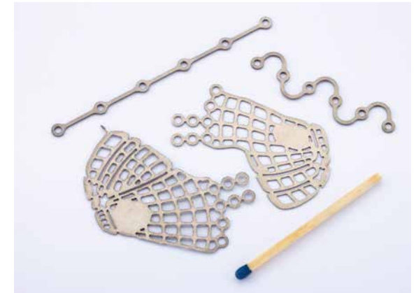
Aus Titanblech geschnittene Implantate für die Rekonstruktion schwerer Gesichtsverletzungen im Augenbrauenbereich © Waterjet
