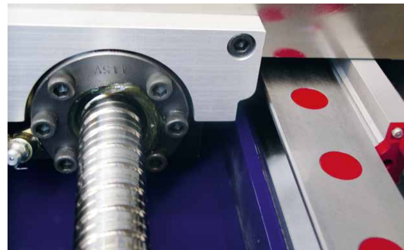
Hochpräzise Kugelrollspindeln sorgen für die genaue Positionierung des Schneidkopfs © Waterjet
