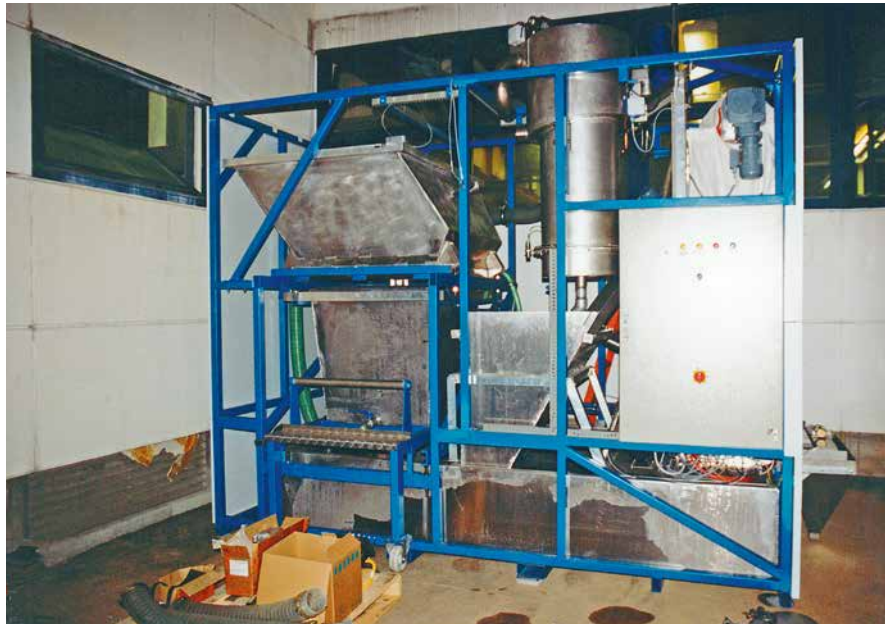
Recyclinganlage für gebrauchten Abrasivsand © Waterjet
