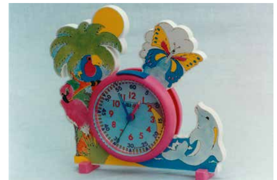
Mit dem Wasserstrahl ausgeschnittene Rahmen für Flik-Flak Kinderwecker von Swatch © Waterjet
