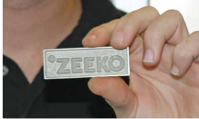
Die 3D-Fräsbearbeitung mit dem Wasserstrahl gelingt auch bei Metall © Klaus Vollrath
