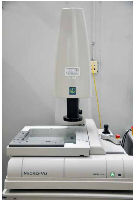
Hochpräzises optisches Multisensor-Koordinatenmessgerät in der Qualitätskontrolle © Waterjet
