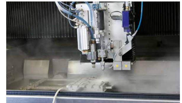
Test mit der 3D-Wasserstrahl-Frästechnologie im Rahmen des Conform-Jet-Projekts © Klaus Vollrath
