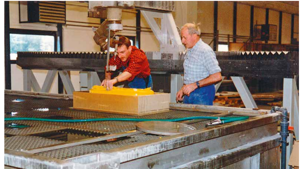
3D-Zuschnitt der Kontur eines Materialschlittens für Rettungseinsätze des Militärs © Waterjet
