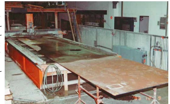
Bearbeitung übergrosser Teile auf der verlängerten Wasserstrahlschneidmaschine © Waterjet
