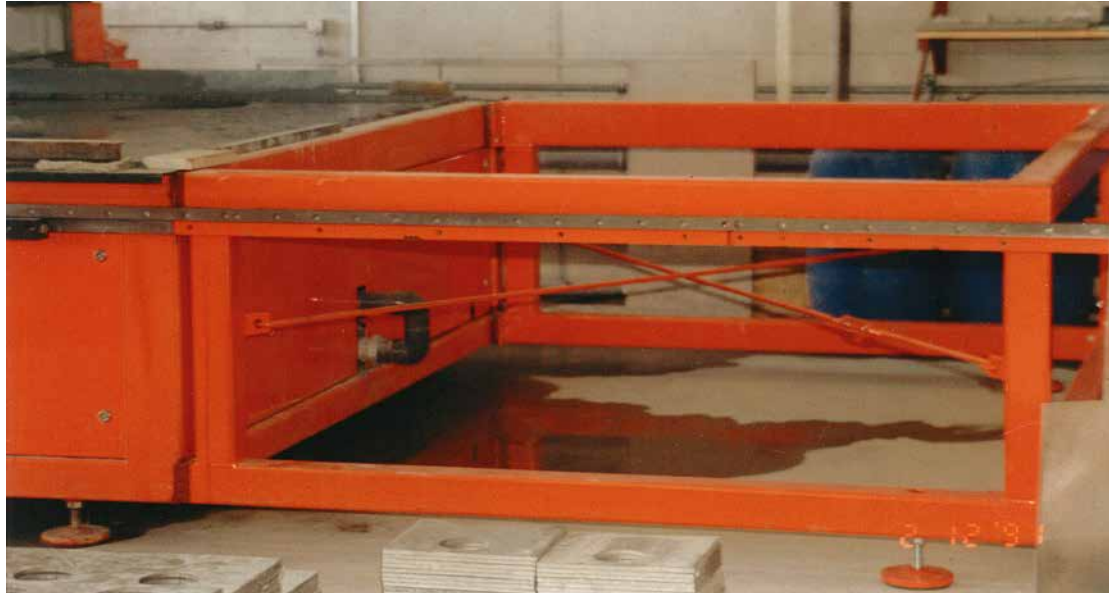
Zusammenbau der verlängerten Schneidmaschine © Walter Maurer
