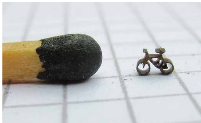
Mit dem Wasserstrahl erzeugtes Mikro-Fahrrad © Klaus Vollrath
