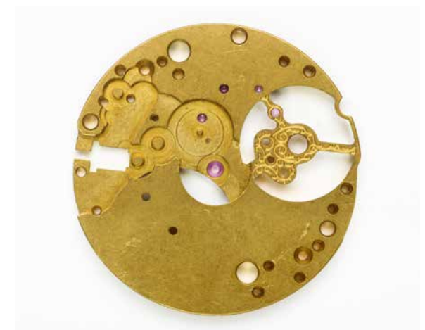
Mit dem Wasserstrahl nach dem Einpressen der Rubine präzisionsgeschnittene Uhrenplatine © Waterjet
