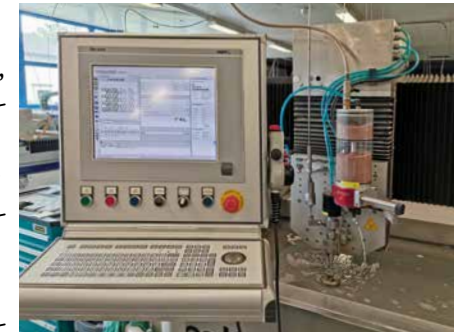
Von Firma W. Althaus geliefertes Steuerpult für eine Mikro-Wasserstrahl-schneidanlage © Klaus Vollrath
